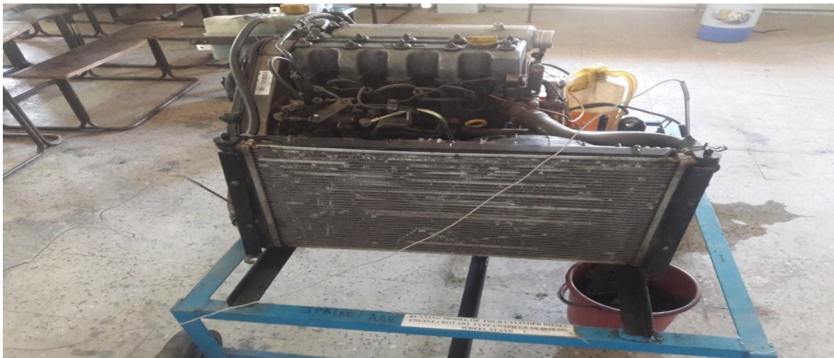
Fig. 2 Actual Experimental Radiator Test-rig.
